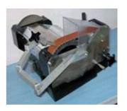
L'affilage consiste à entretenir les angles du taillant et à redresser, à recentrer le fil de la lame à l'aide d'une pierre ou d'un affiloir avec un angle identique à l'angle d'affûtage.
