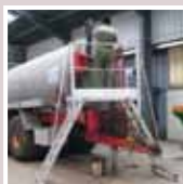
Plateforme Individuelle Roulante (PIR)
